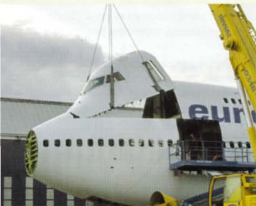
Het bovendek van deze 747 wordt met zwaar materieel verwijderd.
